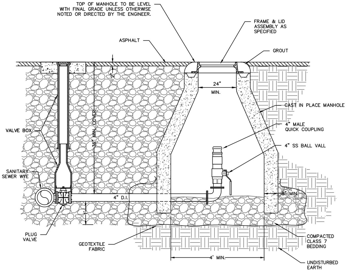
NOTE: SEE PUMP STATION PLAN FOR LOCATION AND CONFIGURATION OF ASSEMBLY.
